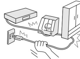
傷つけたり、加工したり、重いものをのせたり、加熱したり、熱器具に近づけたり、無理に曲げたり、ねじったり、引っぱったりすると芯線の露出・ショート、断線により火災・感電の原因となります。
